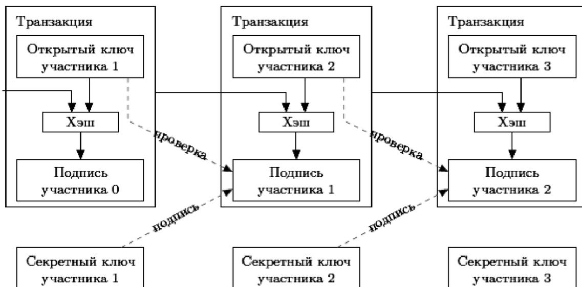
Рис. 1. Схема подтверждения правомерности совершения транзакции
