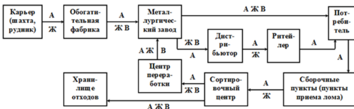
Рис. 1. Схема реверсивной логистики производства металлопродукции и переработки металлолома с указанием участия различных видов транспорта в обеспечении перевозок на отдельных этапах: А – автомобильный транспорт; Ж – железнодорожный транспорт; В – водный транспорт
