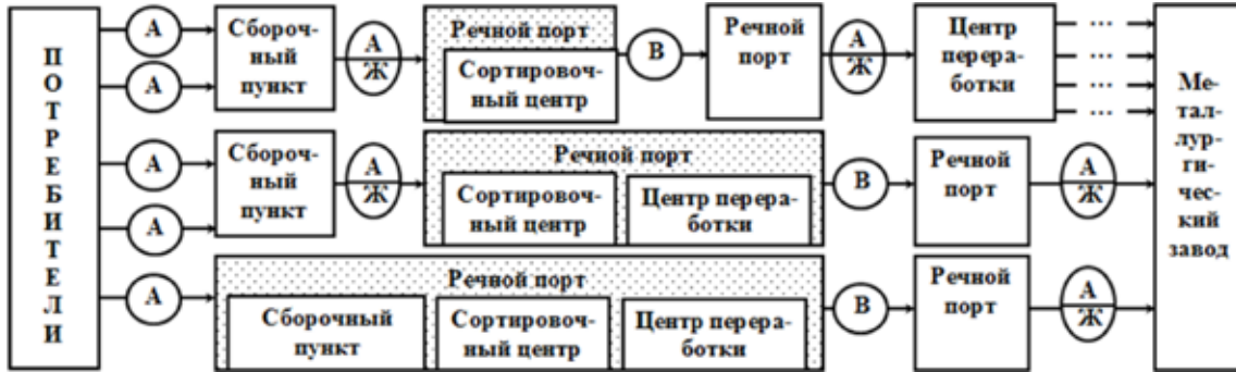
Рис. 3. Транспортно-логистические схемы доставки металлолома с различными вариантами расширения участия речных портов в системе реверсивной логистики производства металлопродукции: А – автомобильный транспорт; Ж – железнодорожный транспорт; В – водный транспорт
