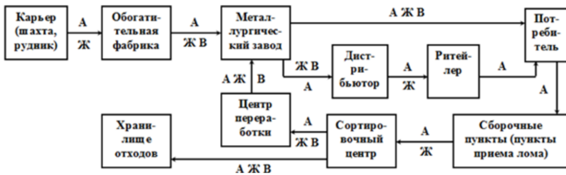
Рис. 1. Схема реверсивной логистики производства металлопродукции и переработки металлолома с указанием участия различных видов транспорта в обеспечении перевозок на отдельных этапах: А – автомобильный транспорт; Ж – железнодорожный транспорт; В – водный транспорт
