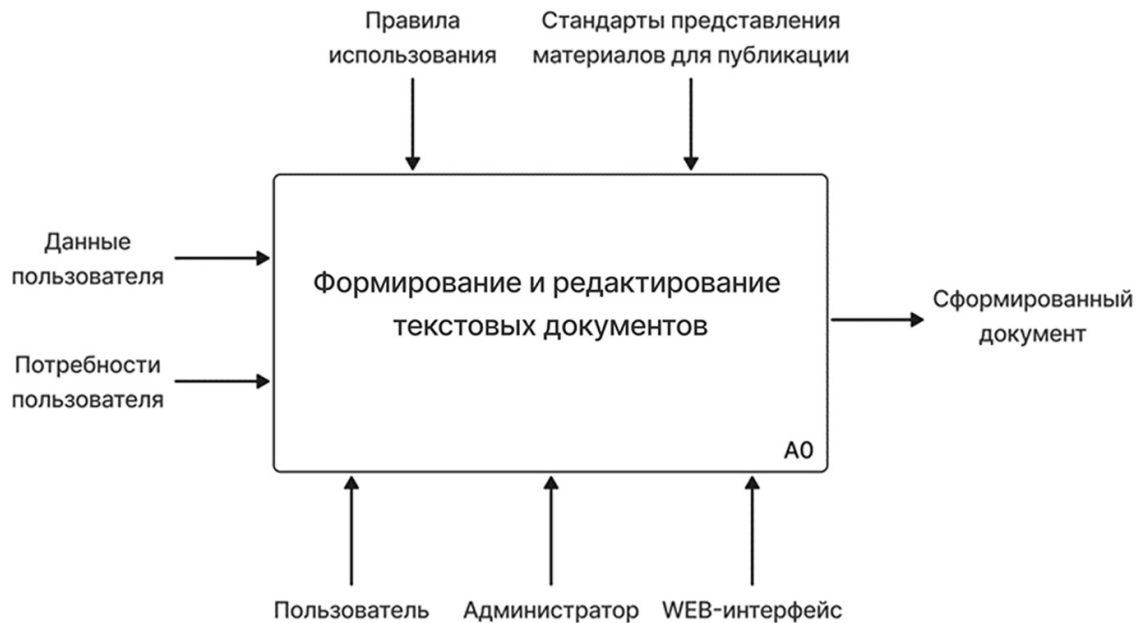
Рис. 1. Контекстная диаграмма функциональной модели Источник: составлено авторами с использованием редактора векторной графики Figma
